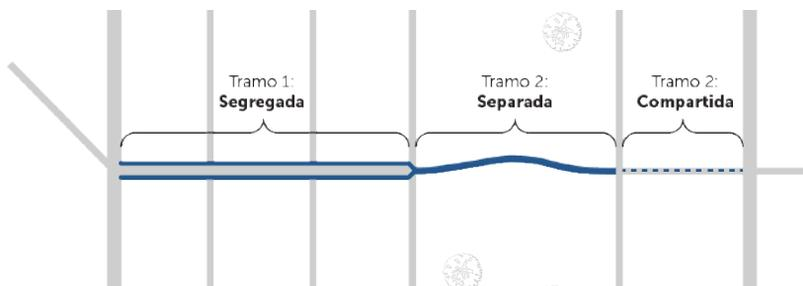
Figura 31. Definición de las tipologías por tramo. Fuente: Elaboración propia.
