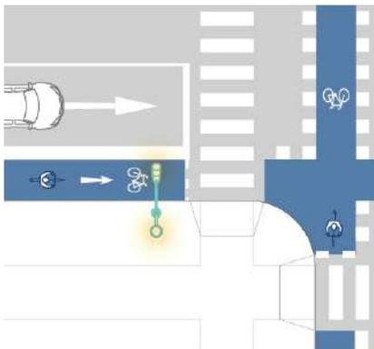
Figura 87. Iluminación adecuada en las intersecciones. Fuente: Elaboración propia.
