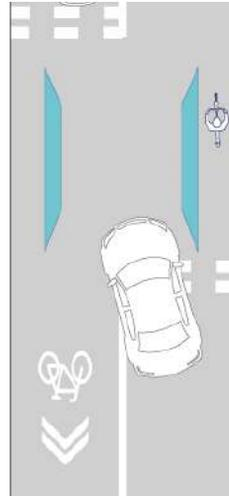
**Figura 83.** Estrechamiento lateral permeable. Fuente: Elaboración propia.
