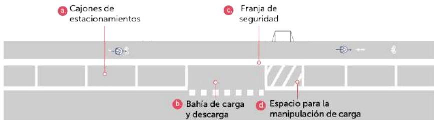
**Figura 103.** Solución carga y descarga en faja de estacionamientos. Fuente: Elaboración propia adaptado de Guía Técnica Extendida Para Bahías de Carga y Descarga (p. 41), por GIZ-Ricardo, 2022.
